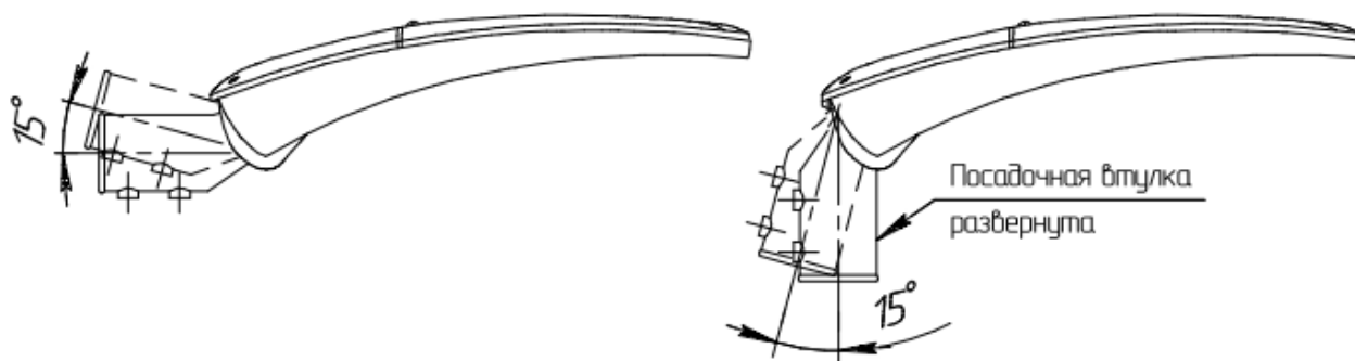
Рисунок 1.3 – Углы наклона светильника
